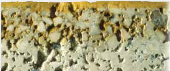
Résultat : BEECK REINKRISTALLIN et la surface du support minéral forment une unité indivisible et microporeuse, donc extrêmement favorable à la diffusion de la vapeur d'eau. Purement inorganique, extrêmement favorable à la respiration du support, stable aux rayons UV.
